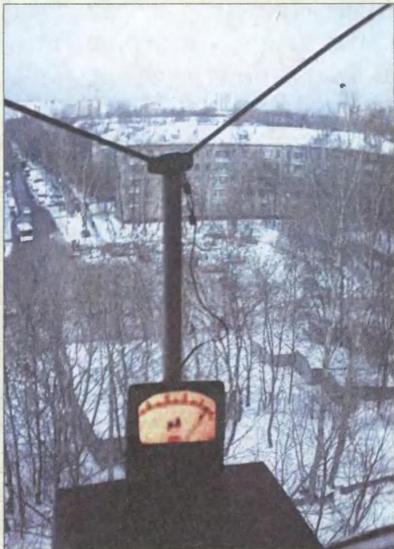
индикатор все равно окажет большую помощь при выборе места установки телевизионной или радиовещательной УКВ-антенны — ее ведь надо располагать там, где максимум поля — только так вы получите чистый сигнал без помех и искажений. В разных местах моего балкона, например, показания индикатора от поля УКВ ЧМ-радиостанций изменялись от 1200 до 10 мВ.
